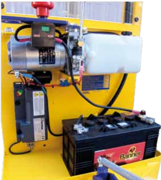
Eingebautes Ladegerät, Batterie 12 V, Pumpengruppe, Not-Aus-Taster
